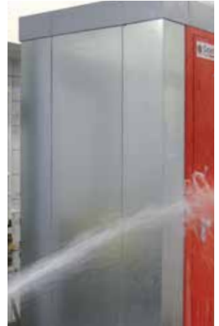
Test gegen starkes Strahlwasser
