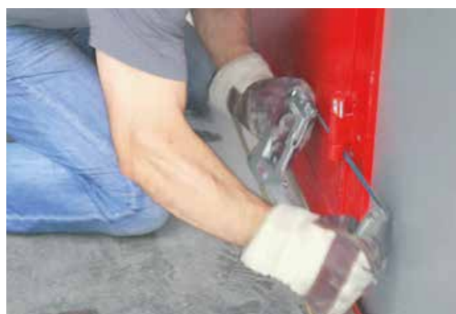
Ensayo de intrusión: ataque a las bisagras
