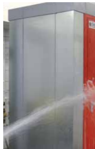
Ensayo con chorros de agua a alta presión
