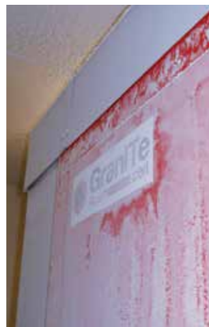
Muestra de ensayo después de ensayo de impermeabilidad contra polvo
