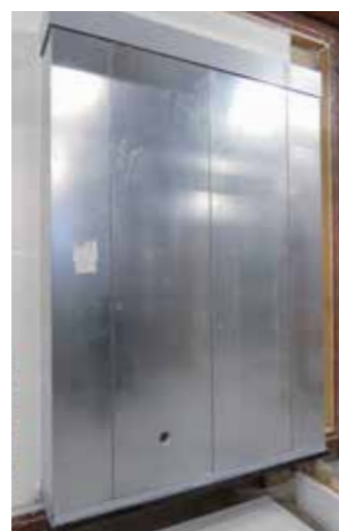
Muestra de ensayo dentro de la cámara de protección contra humo
