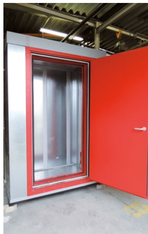
Испытуемый образец перед камерой для тестирования защиты от дыма
