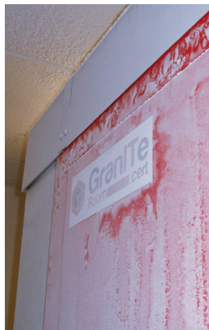
Испытуемый образец после испытания защиты от пыли
