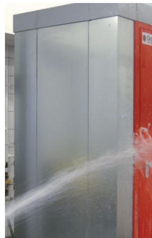
Испытание струями воды под высоким давлением
