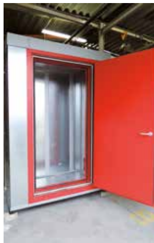
Corps d'essai sans chambre de protection contre la fumée
