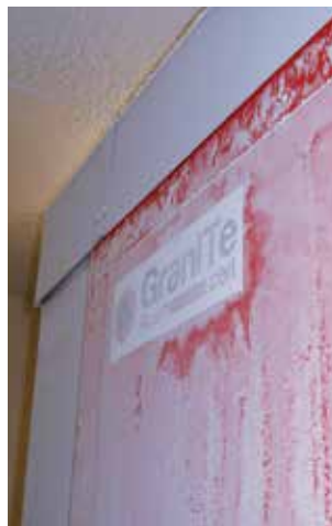
Corps d'essai après l'essai d'étanchéité à la poussière
