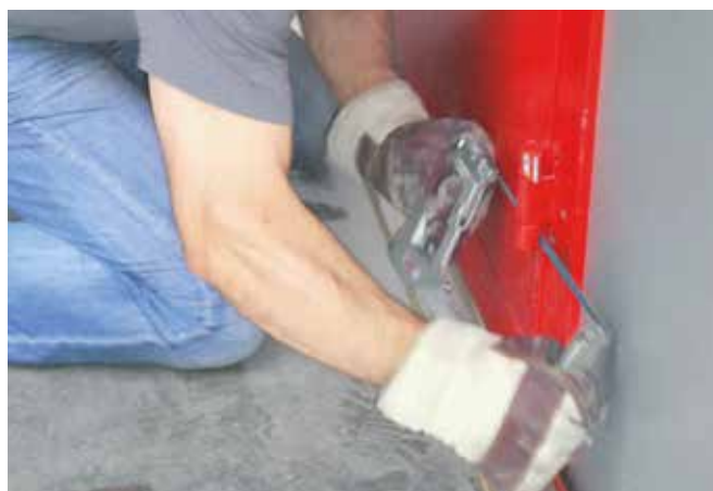
Essai d'effraction : tentative d'effraction au niveau des charnières
