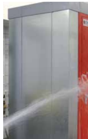
Essai de résistance à un puissant jet d'eau
